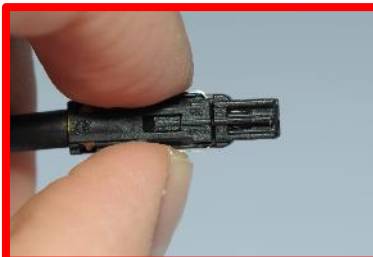
Abbildung 6-4 Falsche Handhabung (Bsp. AMEC)
