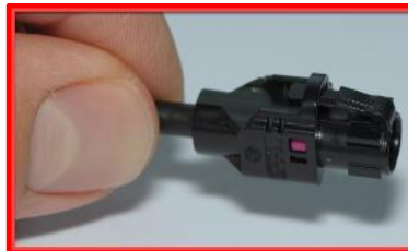
Abbildung 6-2 Falsche Handhabung (Bsp. H-MTD)
