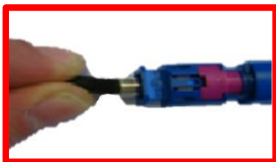
Abbildung 6-1 Falsche Handhabung (Bsp. HSD)
