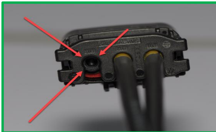
Abbildung 5-9 Kontrolle Blindstopfen (Bsp. AMEC)
