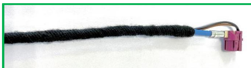
Abbildung 5-6 Bandagieren von MQS-Litzen
