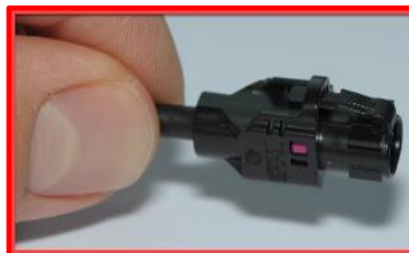
Figure 6-2 Incorrect handling (example: H-MTD)
